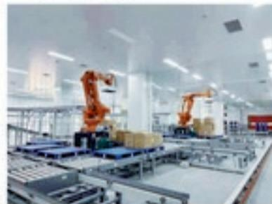
车间生产的成品由产线对接的输送机,(产线末端设有扫码扫描、异常剔除环节),输送到往复提升机、螺旋提升机,再经过箱式输送机输送至 1 楼码垛区。码垛区配有两套 ABB 机械手,每套机械手负责 7 个码垛区,每套机械手效率为 300 托/小时。成品由码垛区处的条码扫描器扫描药品监管码后,由系统分配至不同码垛区域进行码垛,码垛结束后,经外形检测,进入立库区域进行存储。成品的入库从产线末端至仓库货架上,全部由仓储物流设备完成入库作业。实现了自动化、无人化的作业功能。成品由机械手码垛入库时,wcs 系统同时将入库的数量回传给 wms 系统,实现了实时记账功能,无需人工收货、入库、记账。此功能不仅提高了入库的效率、数据的准确性,而且缩减了仓库的人员配置。
