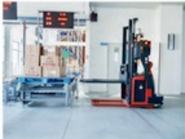
车间需要领料时,在 WMS 系统里点下发指令。系统接受指令后,分配 AGV 小车将物料送至各车间的不同的区域。车间退料时,在 ERP 系统中退料单,车间人员在 RF 手持中做入库组盘,WCS 系统根据任务分配 AGV 小车将车间托盘送至入库口。物料的发放及退回,由 AGV 替代人工作业。AGV 作业不仅的减少了人员工作量的而且同时也提高了物料发放的效率。值得一提的是 AGV 小车首次采用 5G 通讯技术,对于解决移动设备通讯延时问题,提升系统的灵活性、实时性和安全性发挥了重要作用。
